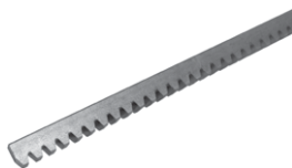
CRIS400 - COD. 162324 Tandlat gegalvaniseerd staal lasbevestiging 22x22x1000 mm M4 (per 10 stuks/verpakt)
