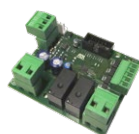
COD. 163676 Module voor het aansturen van RGB-ledstrips of de gesynchroniseerde werking van 2 slagbomen
